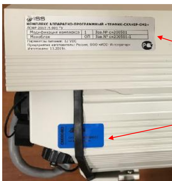
Рисунок 1– Общий вид составных частей Комплексов, места нанесения маркировки, знака утверждения и пломб
