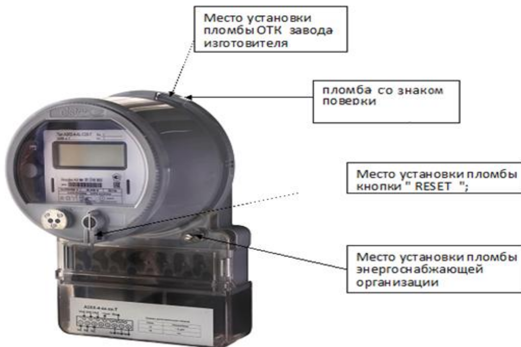
Рисунок 1 – Общий вид счетчика, схема пломбировки от несанкционированного доступа, обозначение места нанесения знака поверки
