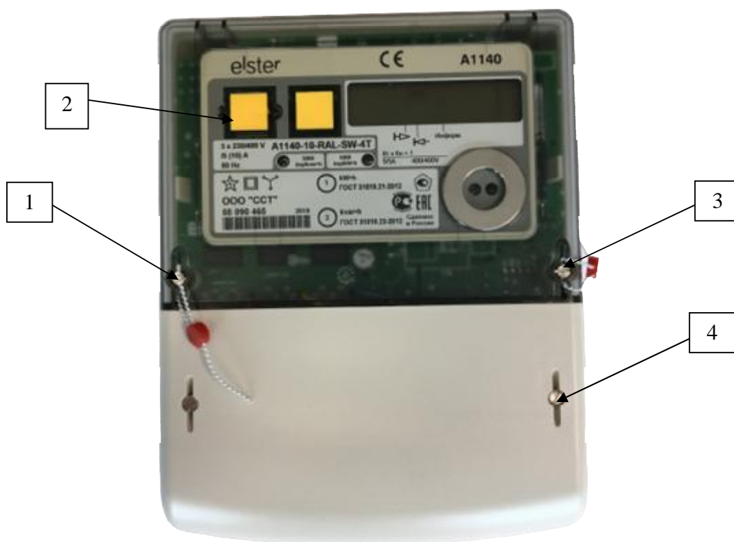
Рисунок 1 – Общий вид счетчика, схема пломбировки от несанкционированного доступа, обозначение места нанесения знака поверки
