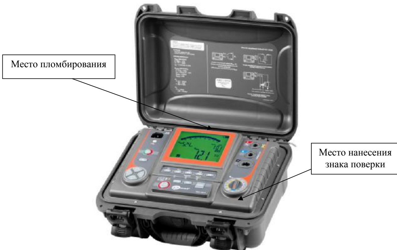
Рисунок 2 – Общий вид измерителей модификации МІС-5010, место нанесения знака поверки и места пломбирования
