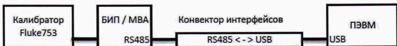
Рисунок 1 - Схема подключения для опробования и подтверждения соответствия программного обеспечения
