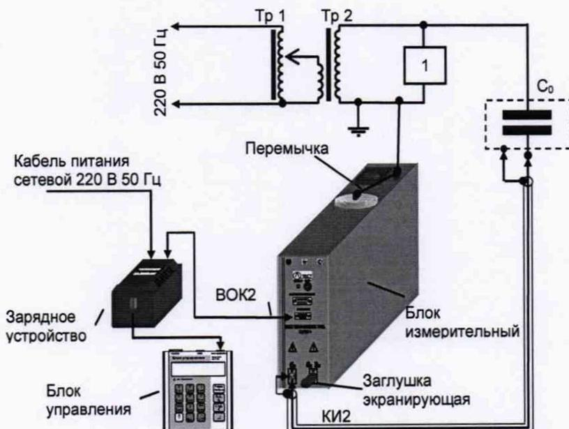
Tr1 – лабораторный автотрансформатор ЛАТР-2,5; Tr2 – трансформатор питающий;
