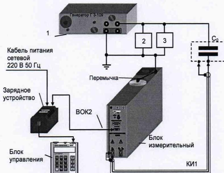
1 – генератор ГЗ-109; 2- вольтметр В7-35; 3 – частотомер ЧЗ-63/1;  $C_0$  – эталонный конденсатор
