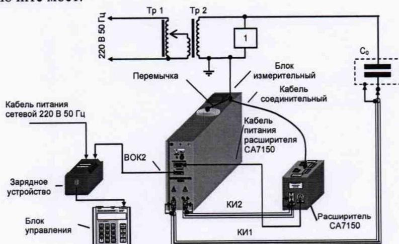
$Tr_1$  – лабораторный автотрансформатор ЛАТР-2,5;  $Tr_2$  – трансформатор питающий; 1 – вольтметр В7-35;
