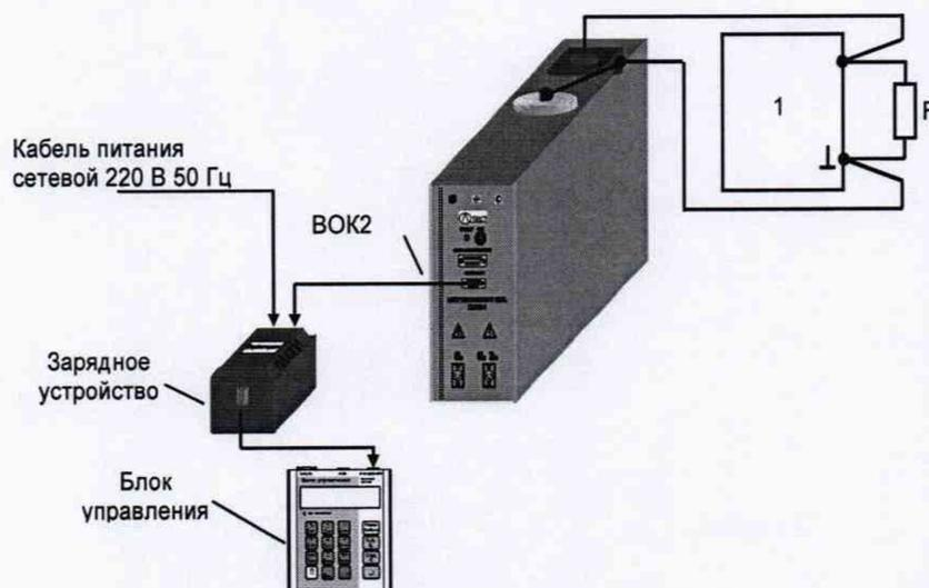
1 – киловольтметр С502 или вольтметр В7-35; R- резистор , 1,5 МОм.
