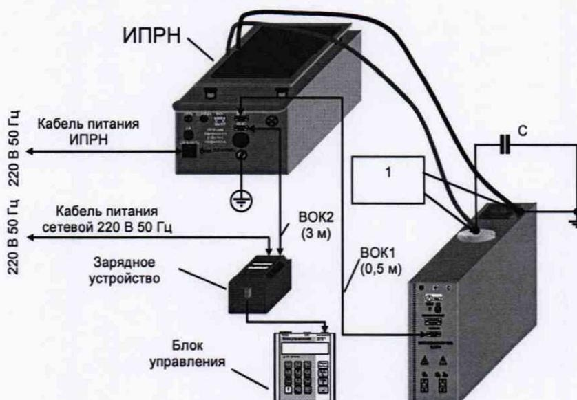
1 – киловольтметр С196; С – конденсатор, 100 нФ (СК-10,5-100-2УЗ)
