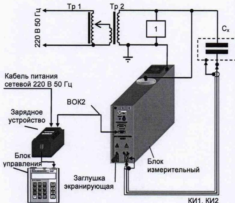
Tr1 – лабораторный автотрансформатор ЛАТР-2,5; Tr2 – трансформатор питающий;
