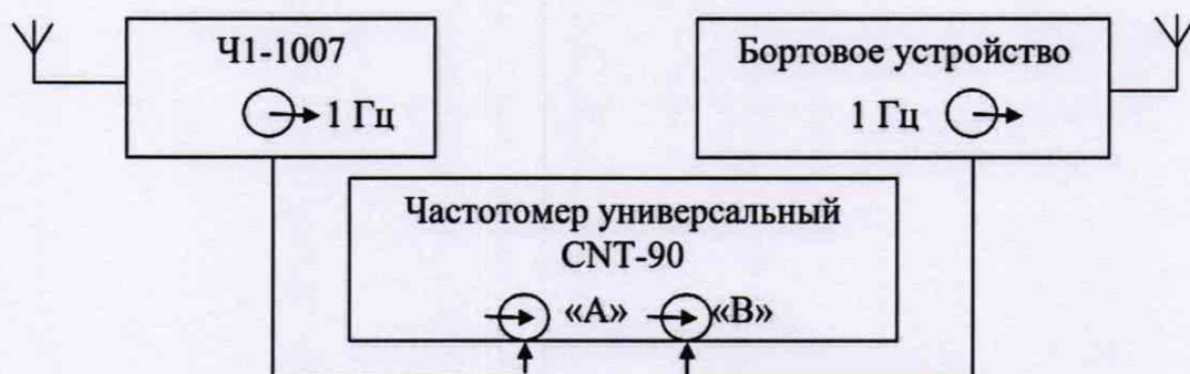
Рисунок 2 — Схема для определения смещений формируемой ШВ относительно ШВ UTC(SU) в режиме синхронизации по сигналам НКА
