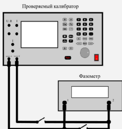
Рисунок 13.9 – Измерительная схема для определения погрешности установки угла фазового сдвига на выходе двухканального генератора методом прямых измерений
