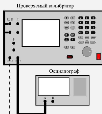
Рисунок 13.10 – Измерительная схема для проверки параметров сигналов специальной формы, воспроизводимых с выхода двухканального генератора
