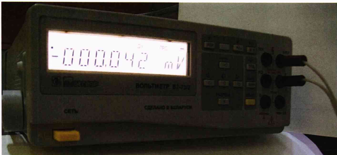
Рисунок 5.6 –Подключения на передней панели вольтметра универсального В7-73/2
