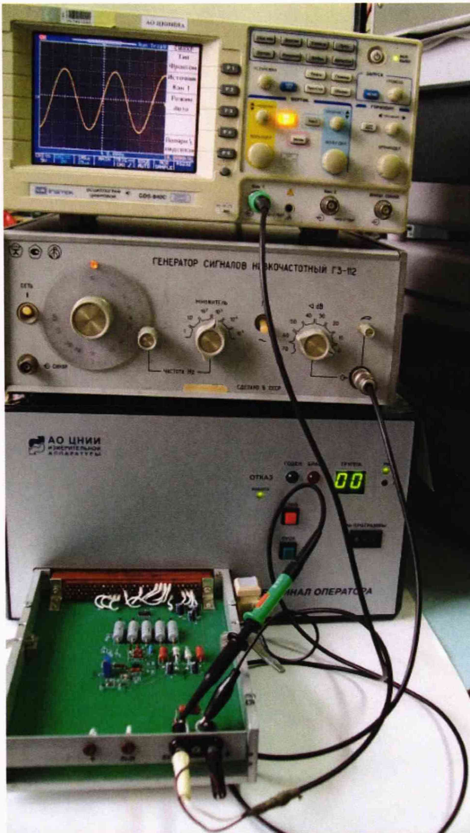
Рисунок 5.17 – Измерение параметров периодического сигнала, формируемого ГЗ-112, эталонным осциллографом GDS-840C и адаптером контроля АЦП-50, подключенным к узлу выходного разъема РМ1 тестера.
