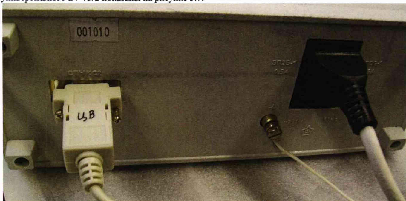
Рисунок 5.7 –Подключения на задней панели вольтметра универсального В7-73/2
