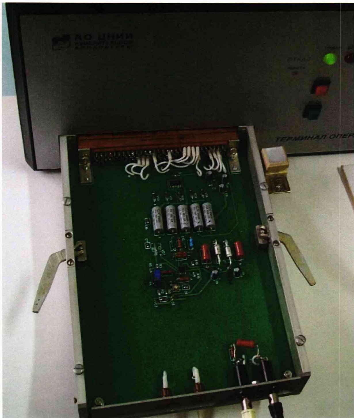
Рисунок 5.16 – подключение адаптера контроля АЦП-50 к узлу выходного разъема РМ1.
