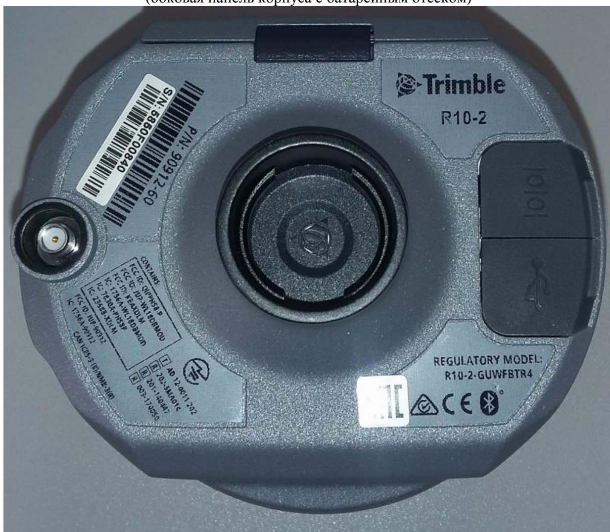
Рисунок 3 – Внешний вид аппаратуры (нижняя панель, идентификационные таблички)
