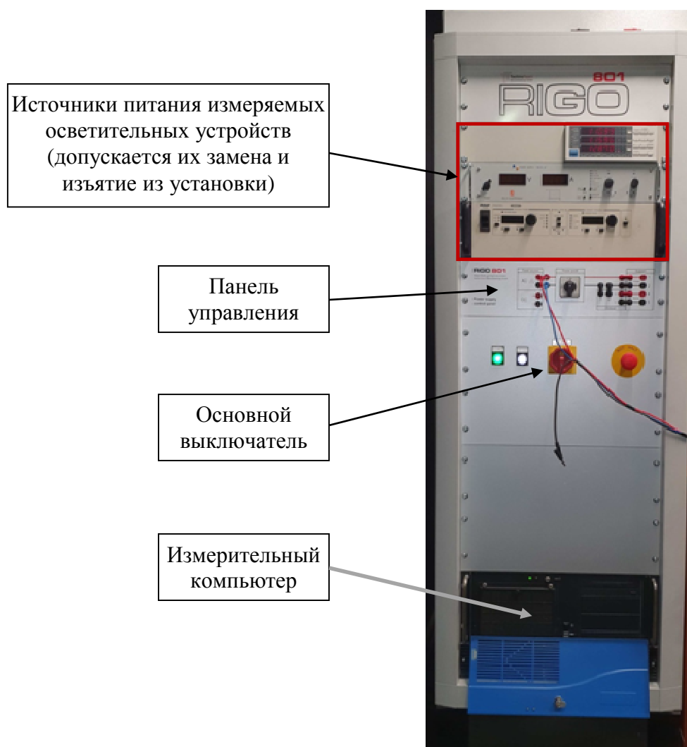
Рисунок 2 – Общий вид электрического шкафа управления гониофотометром
