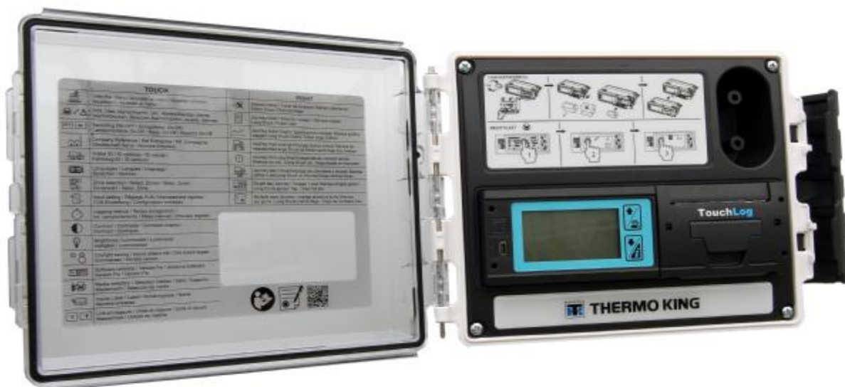
Рисунок 4 – Регистратор в защитном корпусе (для наружного монтажа) в открытом виде
