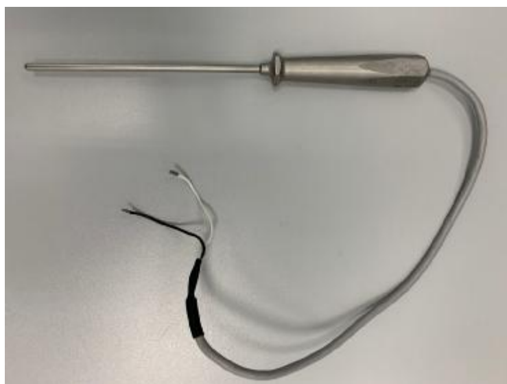
Рисунок 6 – Датчик температуры погружного типа в виде зонда с держателем
