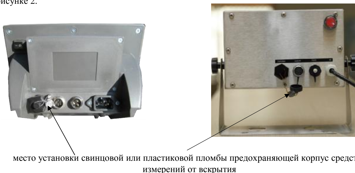
Рисунок 2 – Схема пломбировки средства измерений
