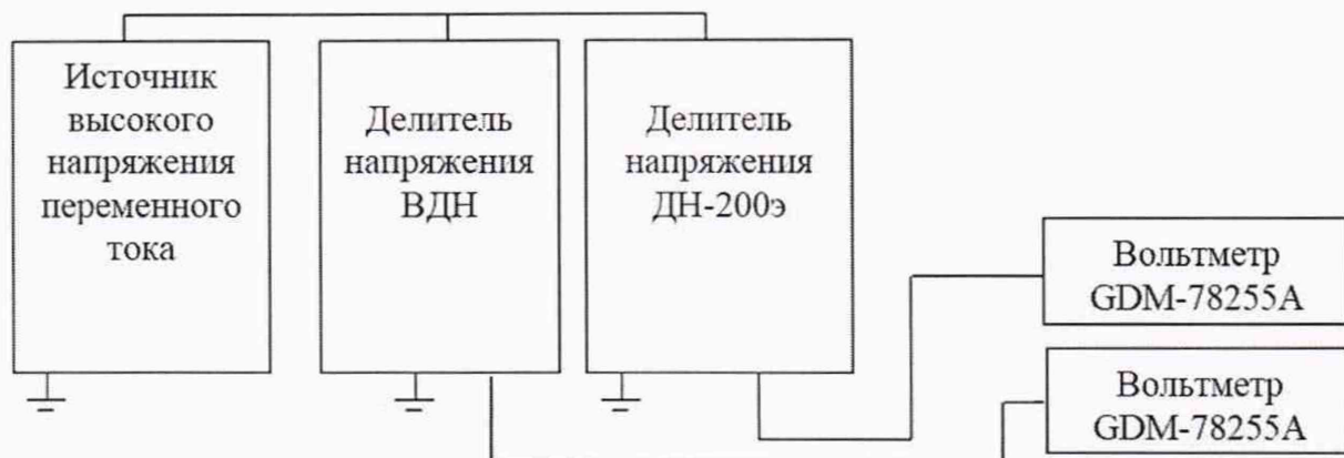
Рисунок 1 - Схема для проведения проверки на напряжении переменного тока
