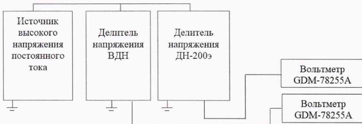
Рисунок 2 - Схема для проведения проверки на напряжении постоянного тока
