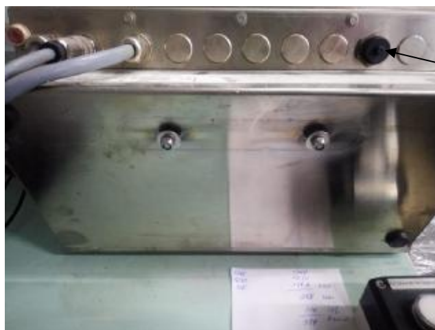
Рисунок 3 - Схема пломбировки индикатора IND690 от несанкционированного доступа, обозначение места нанесения знака поверки
