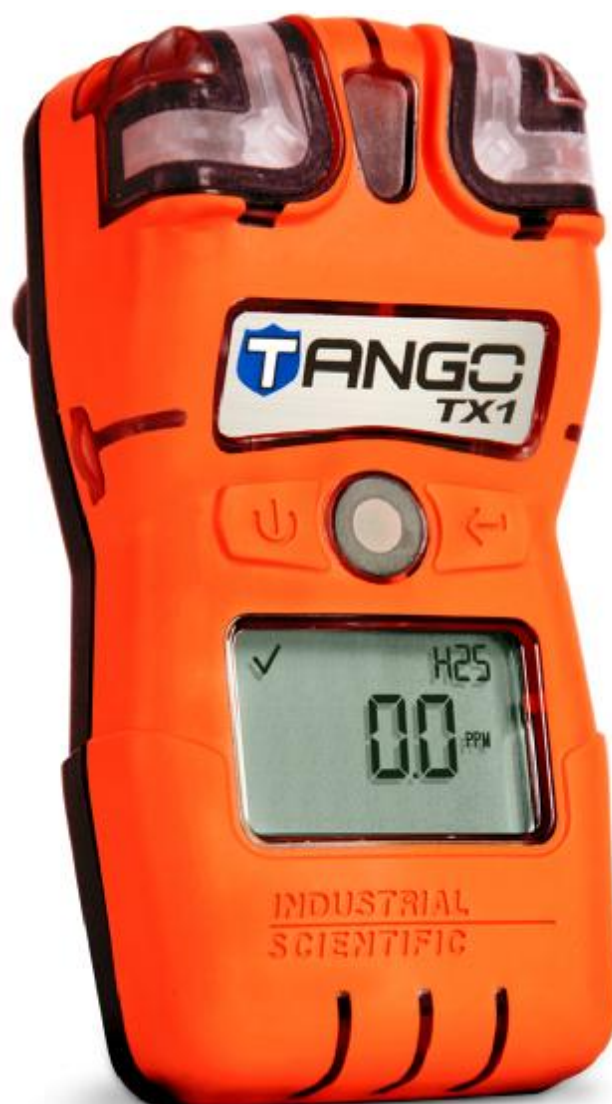
Рисунок 1 – Газоанализатор портативный одноканальный Tango TX1 – общий вид
