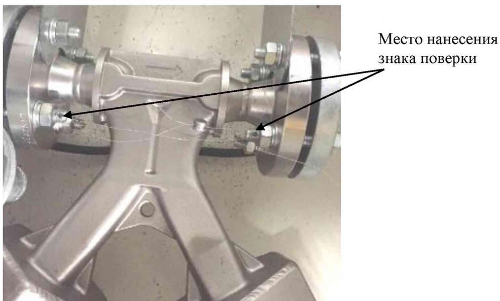
Рисунок 1 - Пломбировка генератора импульсов
