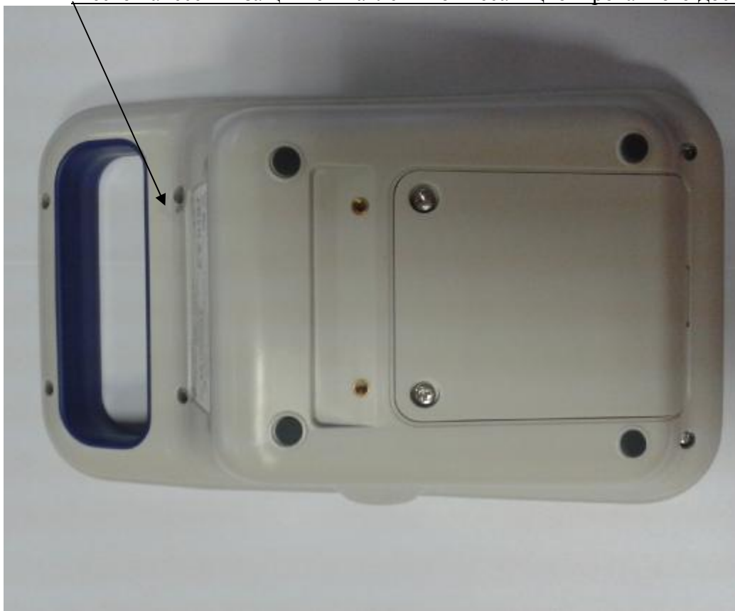
Рисунок 4 – Место нанесения защитной наклейки от несанкционированного доступа HBP-1320 (HBP-1320-E)
