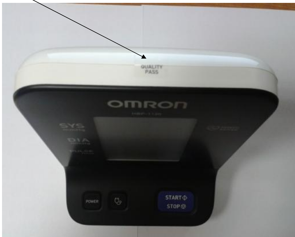
Рисунок 3 – Место нанесения защитной наклейки от несанкционированного доступа HBP-1120 (HBP-1120-E)
