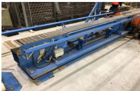
Рисунок 1 - Общий вид ГПУ весов
