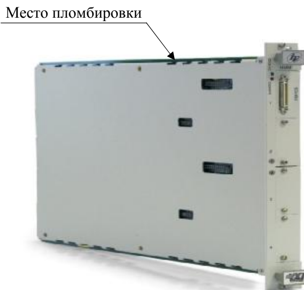
Рисунок 2 – Схема пломбировки от несанкционированного доступа
