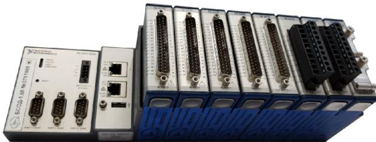
Рисунок 2 - Общий вид блоков сбора и обработки данных БСОД-1.хх - восьмимодульное исполнение корпуса
