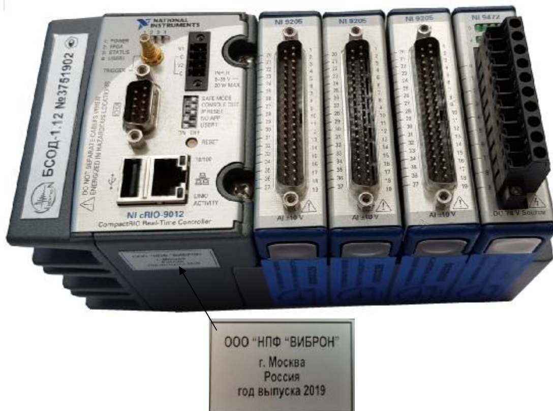
Рисунок 1 - Общий вид блоков сбора и обработки данных БСОД-1.хх - четырехмодульное исполнение корпуса и маркировочная табличка
