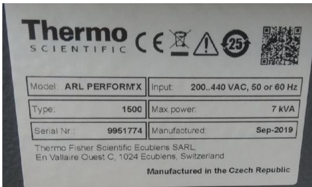
Рисунок 1 – Образец маркировочной таблички, где Model: ARL PERFORM'X – тип спектрометра; Type: 1500 - тип для мощности рентгеновской трубки
