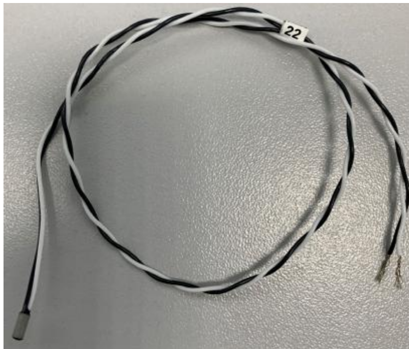
Рисунок 1 – Термопреобразователь сопротивления платиновый HEL705-T-1-12-C1
