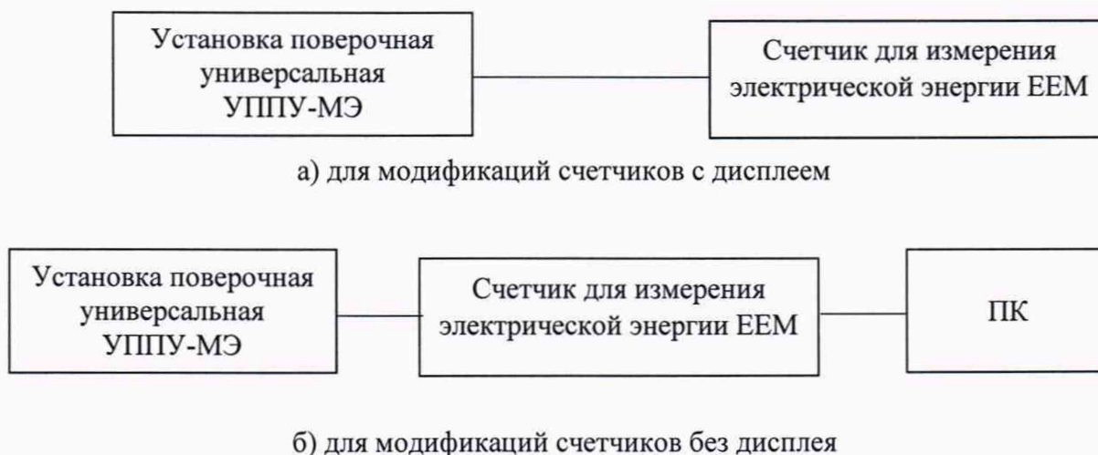
Рисунок 1 – Схемы подключений при определении метрологических характеристик счетчиков модификаций ЕЕМ-МА370, ЕЕМ-МА770, ЕЕМ-МВ370
