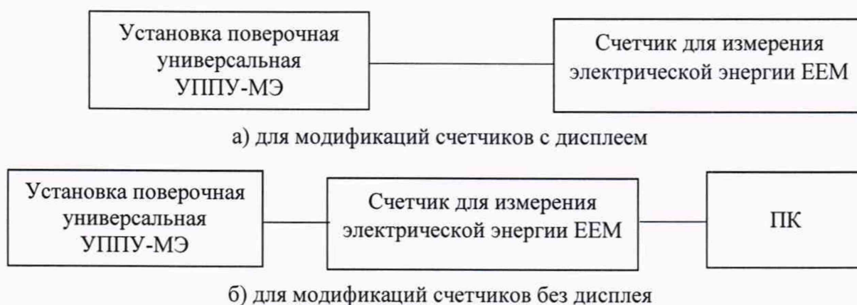
Рисунок 2 – Схемы подключений при определении приведенной (к номинальному значению) погрешности измерений фазного и линейного напряжений переменного тока счетчиков модификаций ЕЕМ-МА371, ЕЕМ-МА771, ЕЕМ-МВ371
