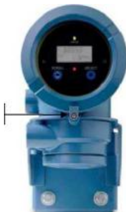
Рисунок 2 - Схема пломбировки СРМ
