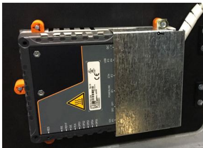
Рисунок 2 – Схема пломбировки от несанкционированного доступа и обозначение мест нанесения знаков на фланцевые соединения средств измерений массы, объема и плотности, и чашечку винта крепления закрывающей пластины контроллера установок
