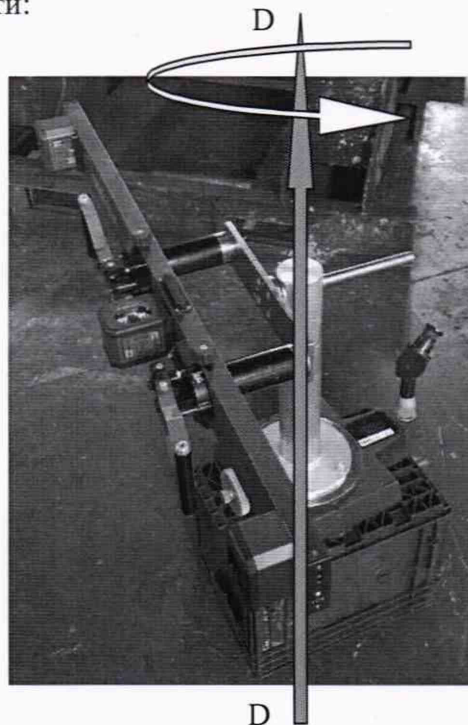
Рис. 1. Схема измерений углов индивидуального схождения ступиц
