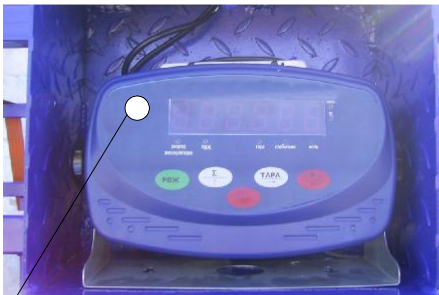
Место нанесения знака поверки
