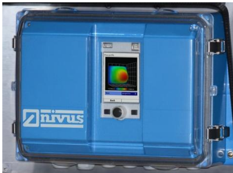
Рисунок 2- Общий вид вычислительного блока расходомеров Nivus моделей NivuFlow 550 и NivuFlow 7550 в корпусе
