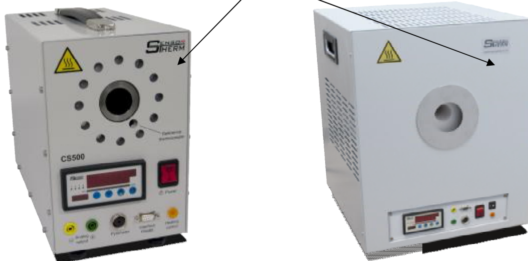
Рисунок 1 - Общий вид средства измерений. Слева источники излучения в виде моделей черного тела CS500, справа - CS1500
