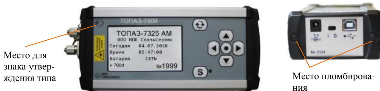
Рисунок 2 – Внешний вид тестера оптического серии ТОПАЗ-7000 в ударозащищенном металлическом корпусе
