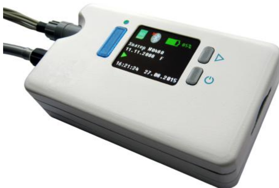
Рисунок 2 – Общий вид регистратора электрокардиосигналов и артериального давления КАРДИОСЕНС АД
