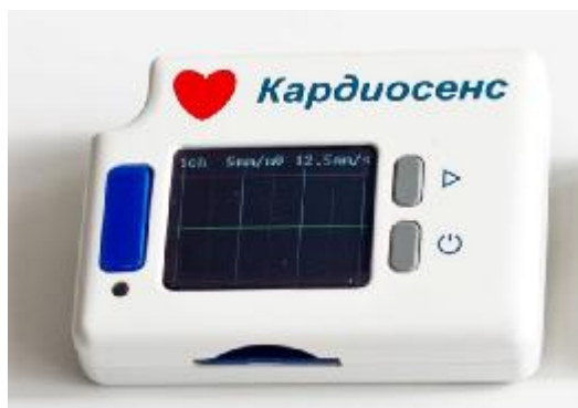
Рисунок 1 – Общий вид регистратора электрокардиосигналов и артериального давления КАРДИОСЕНС К
