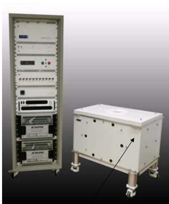
Рисунок 2 - Внешний вид ЯМР-релаксометров GeoSpec+ модификации 2/75 (общий вид блока магнита - слева, общий вид блока электроники - справа)
