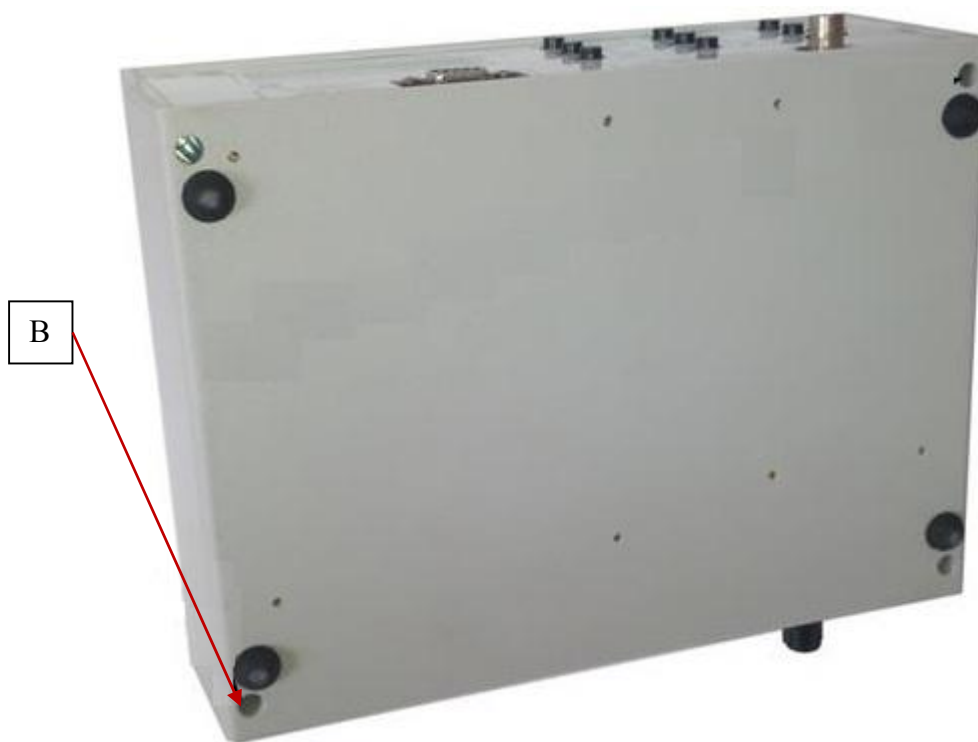
Рисунок 3 – Схема пломбировки от несанкционированного доступа (B)
