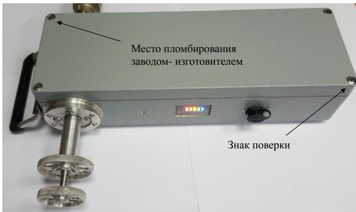
Рисунок 2 – Пломбирование и нанесения знака поверки на установки поверочные «Краб-УМ»
