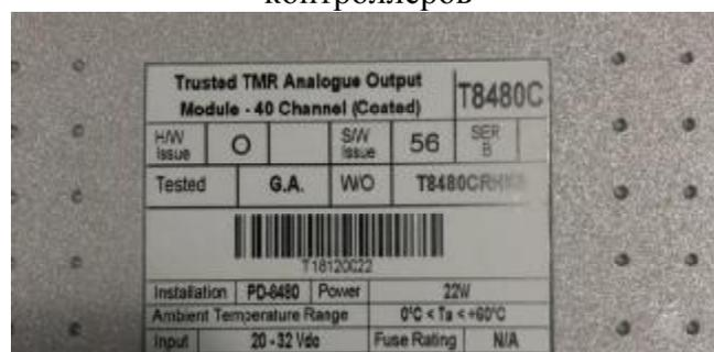
г) модуль вывода Т8480С из состава контроллеров
