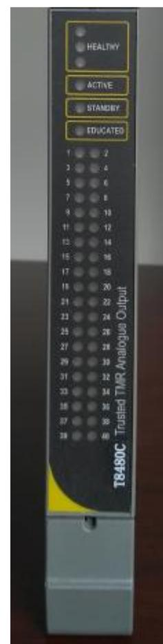
б) модуль вывода Т8480С из состава контроллеров
