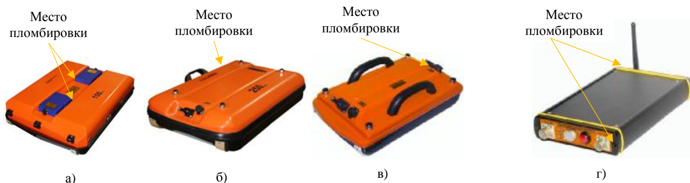
Рисунок 1- Общий вид приборов радиотехнических подповерхностного зондирования (георадаров) ОКО-3 ( а) – в) - антенные блоки АБ-150М3, АБ-250М3, АБ-400М3 соответственно, г) – блок управления БУ)
