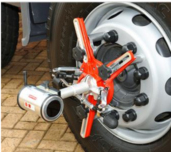
Рисунок 1 – Общий вид устройств для измерений углов установки колес и положения осей автотранспортных средств AXIS4000
