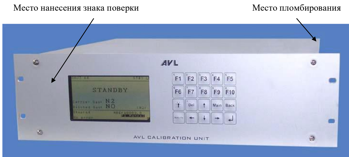
Рисунок 1 – Общий вид генераторов
