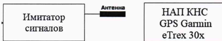
Рисунок 1 – Схема проведения измерений при поверке Аппаратуры
