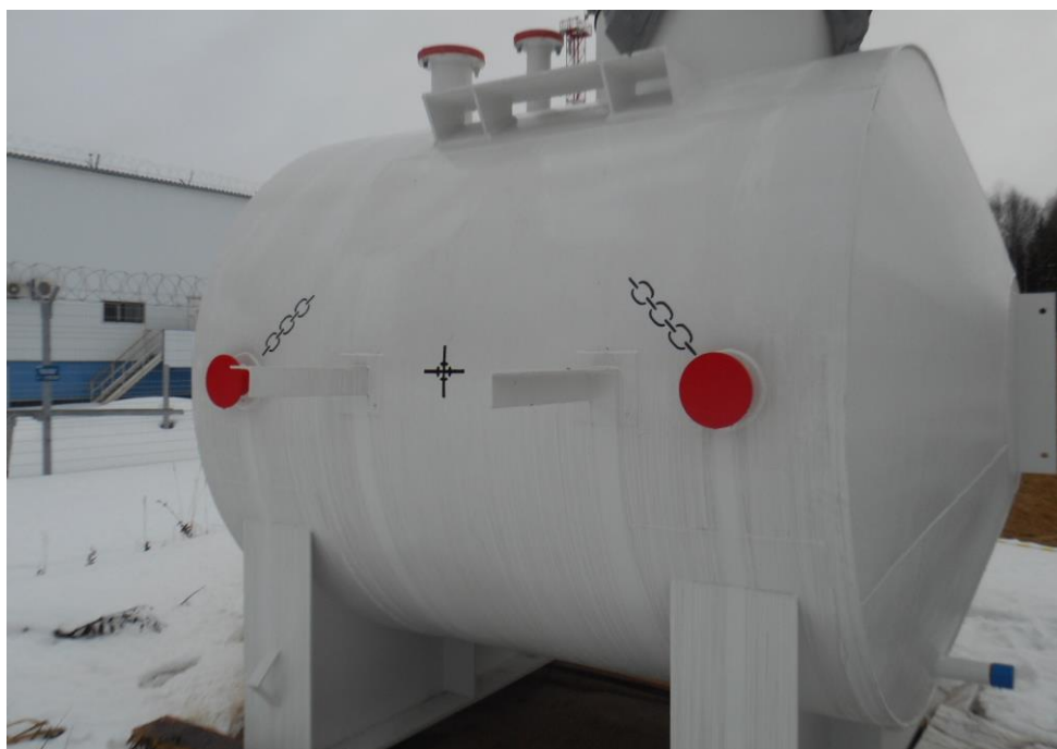
Рисунок 1 – Общий вид резервуаров стальных горизонтальных цилиндрических РГС-5
