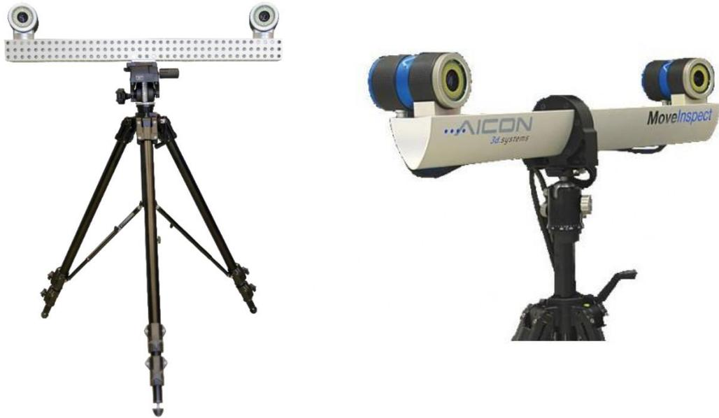
Рисунок 1 – Общий вид системы фотограмметрической измерительной AICON MoveInspect HF4
