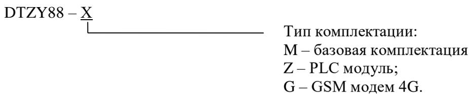
Рисунок 1 - Схема условного обозначения модификаций счетчиков
