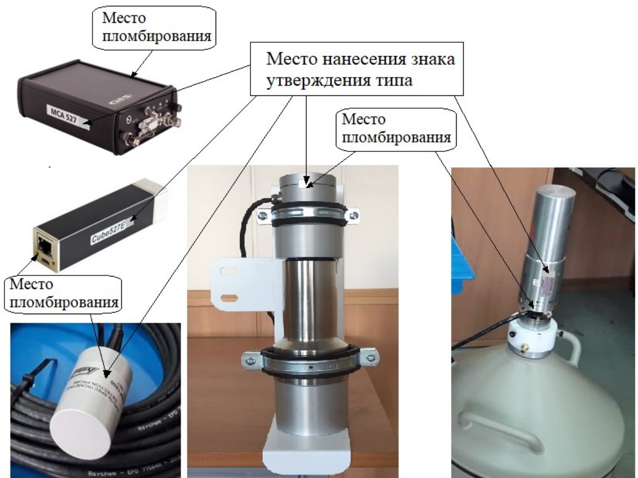
Рисунок 5 – Схема пломбировки от несанкционированного доступа, обозначение места нанесения знака утверждения типа
