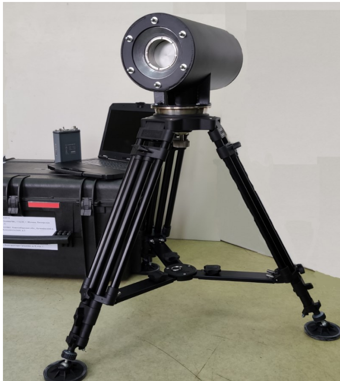
Рисунок 1 – Общий вид СЕГР-МСА527-СЦ базового исполнения стационарного размещения, УДЕГР-ПК-00НС1 в комплекте с ОПК-06
