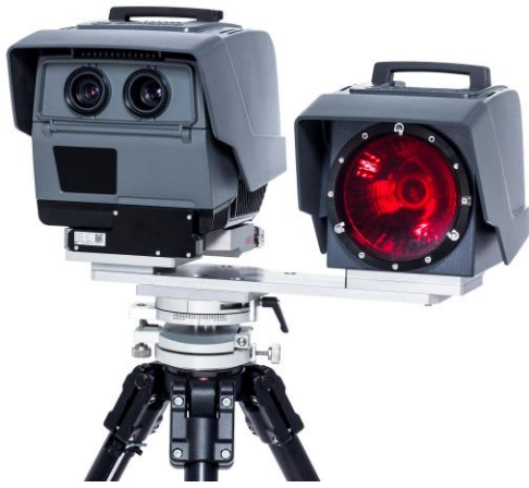
Рисунок 4 – Общий вид измерительного блока со вспышкой расположенных на штативе
