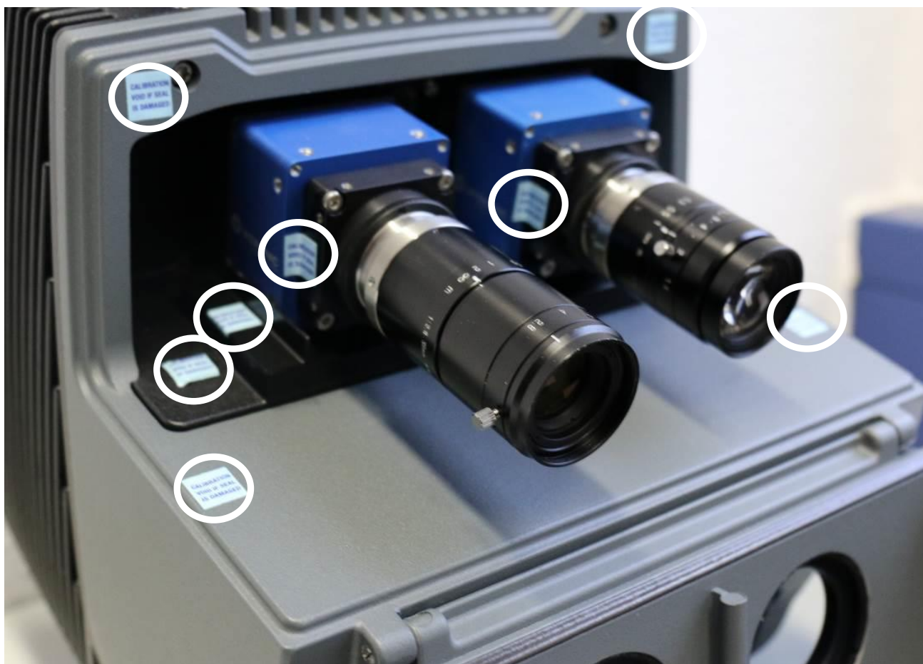
Рисунок 12 – Схема пломбировки от несанкционированного доступа
