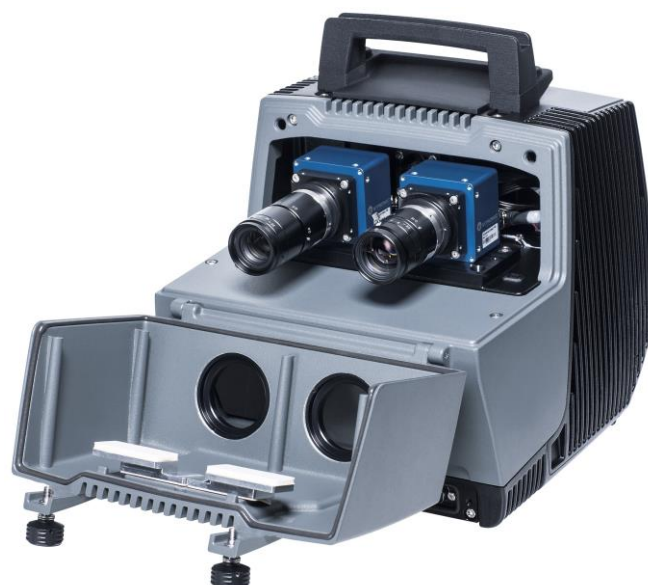
Рисунок 3 – Общий вид измерительного блока в исполнении с двумя камерами (FM1)
