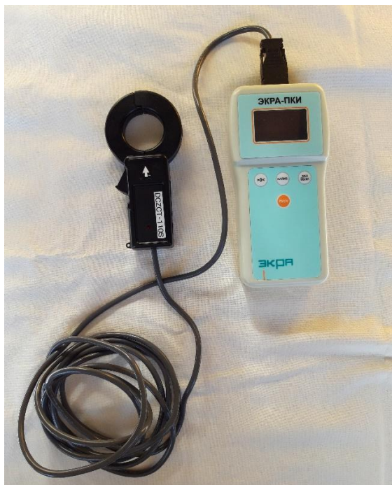
б) Переносное устройство поиска фидеров ЭКРА-ПКИ
