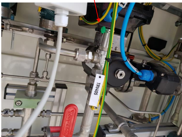
Рисунок 3 – Места нанесения пломбы завода изготовителя к подводщим патрубкам.
