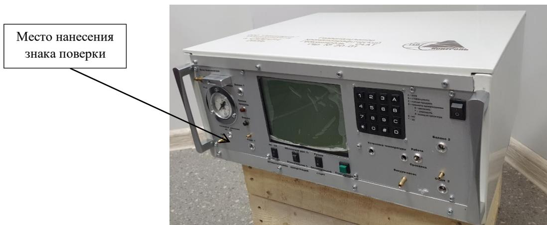
Рисунок 1 – Общий вид обозначение места нанесения знака поверки для газоанализаторов хроматографических Геоконтроль-04АТ
