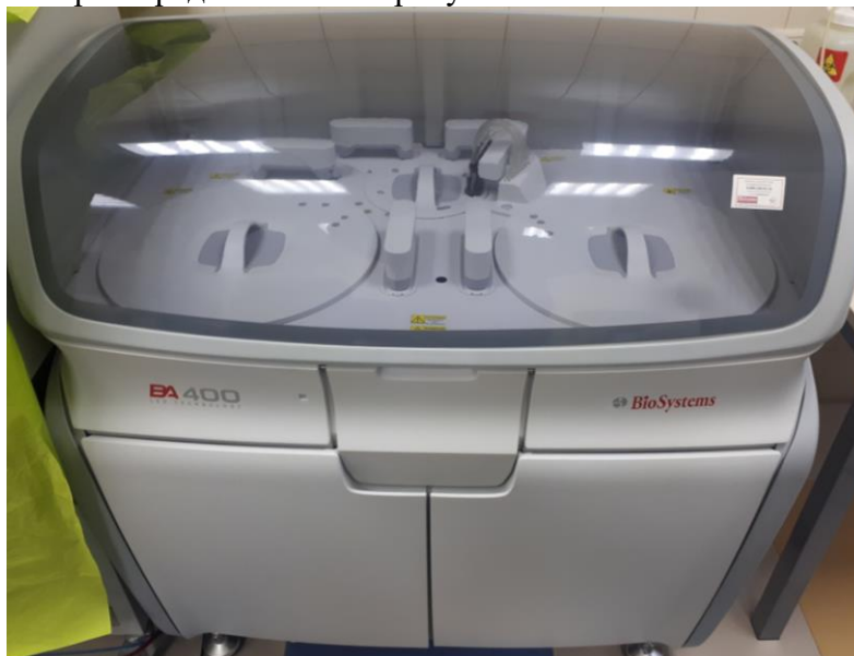
Рисунок 1 - Общий вид анализаторов биохимических лабораторных автоматических ВА400 с принадлежностями
