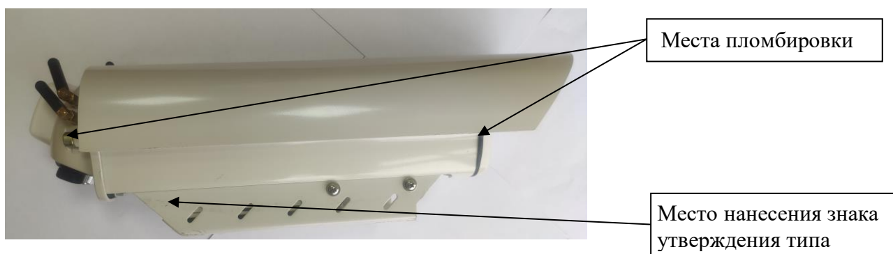
Рисунок 2 – Места нанесения знака утверждения типа и пломбировки от несанкционированного доступа видеорегистратора интеллектуального «ГРОМ-1»
